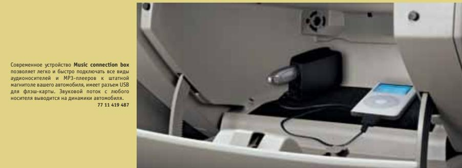
Современное устройство Music connection box позволяет легко и быстро подключить все виды аудионосителей и MP3-плееров к штатной магнитоле вашего автомобиля, имеет разъем USB для флэш-карты. Звуковой поток с любого носителя выводится на динамики автомобиля.
