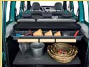
**Водостойкий поддон** дает возможность перевозить мокрые или грязные предметы: он легко извлекается и просто моется.
