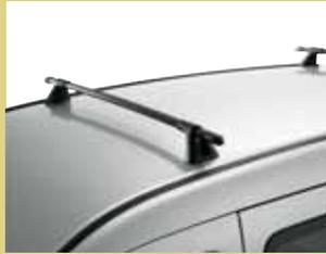
**Багажные дуги** специально разработаны Renault и идеально подходят для Kangoo. Быстро и надежно устанавливаются благодаря наличию специальных пазов на крыше автомобиля и позволяют перевозить до 80 кг, также возможно установить и специальные багажные дуги для крупногабаритного груза, который может достигать 100 кг.
